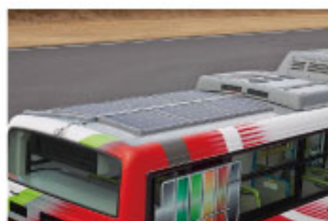
ソーラーパネル Solar PV panels
