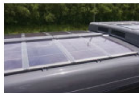
ソーラーパネル Solar PV panels
